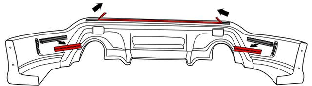
15. 接着テープの保護シートの端を全て5-7cm剥がします。
