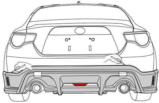
13. リアハーフスポイラーを適切な位置に付け、位置を調節し、マーカで印します。
