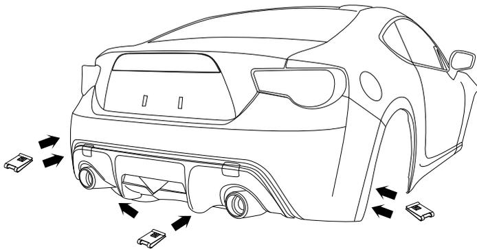
14. クリップナットを取り付け穴に取り付けます。
