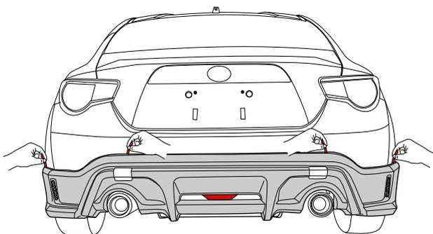
16. バンパーにスポイラーを合わせ、軽く接着面を押し付けます。
