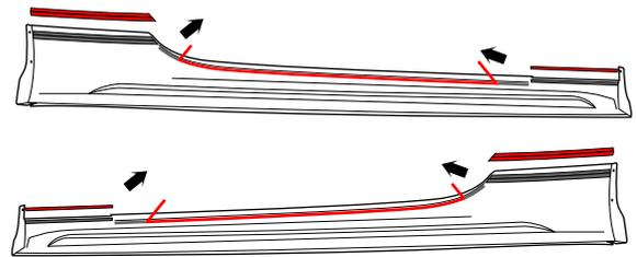
10. 両面テープの保護シートの端を5-7 cmずつ剥がします。
