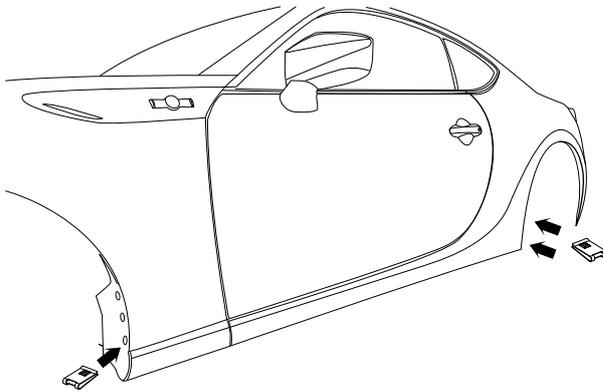
9. クリップナットを取り付け穴に装着します。
