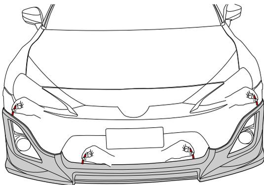
5. バンパーにスポイラーを合わせ、軽く接着面を押し付けます。その後で、全てのテープを剥がします。
