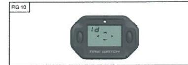
ONの状態から左図 FIG10 になるまでBt1を押したままにします。
