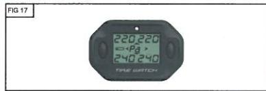
Batteryの絵文字(■)が点滅している場合、バッテリーを交換してください。(CR2450 パナソニック製またはマクセル製)
