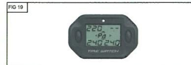
ディスプレイがセンサーの信号を受信できない時は左図のように横棒が表示されます。これが継続する場合はセンサーを交換してください。
