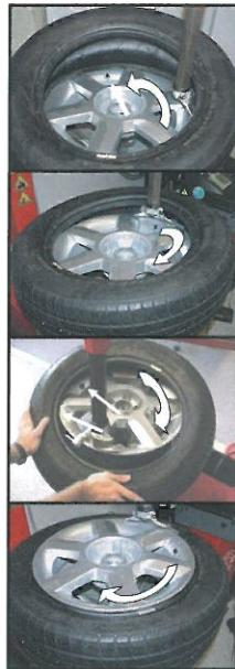
シューをリムとタイヤの交点とバルブの間に入れます。矢印はリムの回転方向を示しています。
