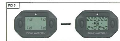
ディスプレイをONにすると、4つのIDが点滅します。36km/h以上の車速にして圧力値が表示されるのを確認します。(タイムアウトは4分)
