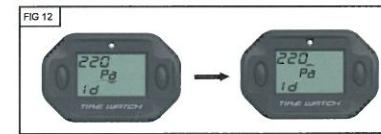
新しいセンサーのIDと位置を認識すると圧力値が表示されます。
