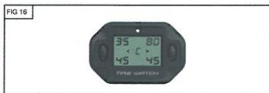
ディスプレイが設定値より高い温度データを受信した場合、ドライバーに警報を発します。°Cの文字と警報値が点滅します。これはタイヤの温度が警報値より下がるまで続きます。(最初の3分間はバックライトが点灯します)
