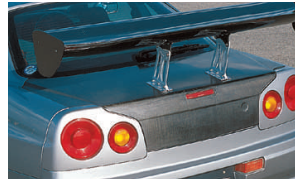
スーパーランクフード (重量: 3.4kg) ノーマルトランク (重量: 24kg)
